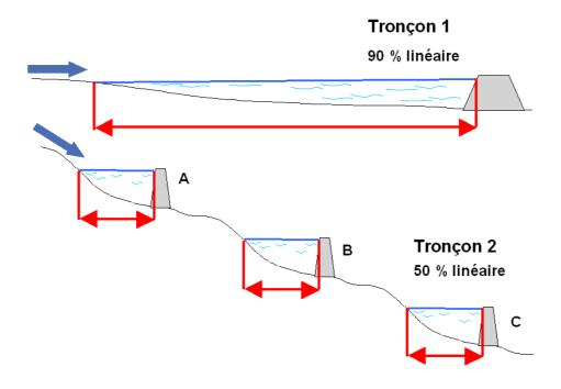
L'évaluation du gain de zones à écoulement libre se fait à partir de l'estimation du linéaire situé sous l'emprise de l'ouvrage grâce aux données hauteur de chute, pente naturelle disponibles et pour être complet largeur naturelle du lit mineur à l'amont du remous. L'estimation du gain écologique doit tenir compte, en plus du linéaire libéré, de la qualité de l'eau et des objectifs DCE (2015 en priorité).
