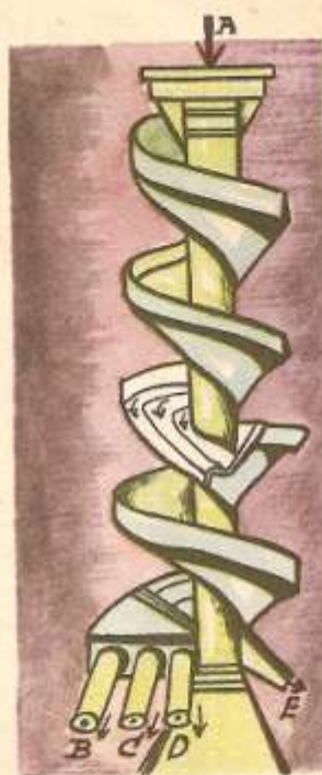
Classeur toboggan pour trier les déchets. — A. Arrivée des grains. — B. Sortie des grains ronds. — C. Des grains mélangés. — D. Du petit blé. — E. Des poussières
