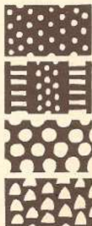
Perforations des cribles dans les appareils de triage.
