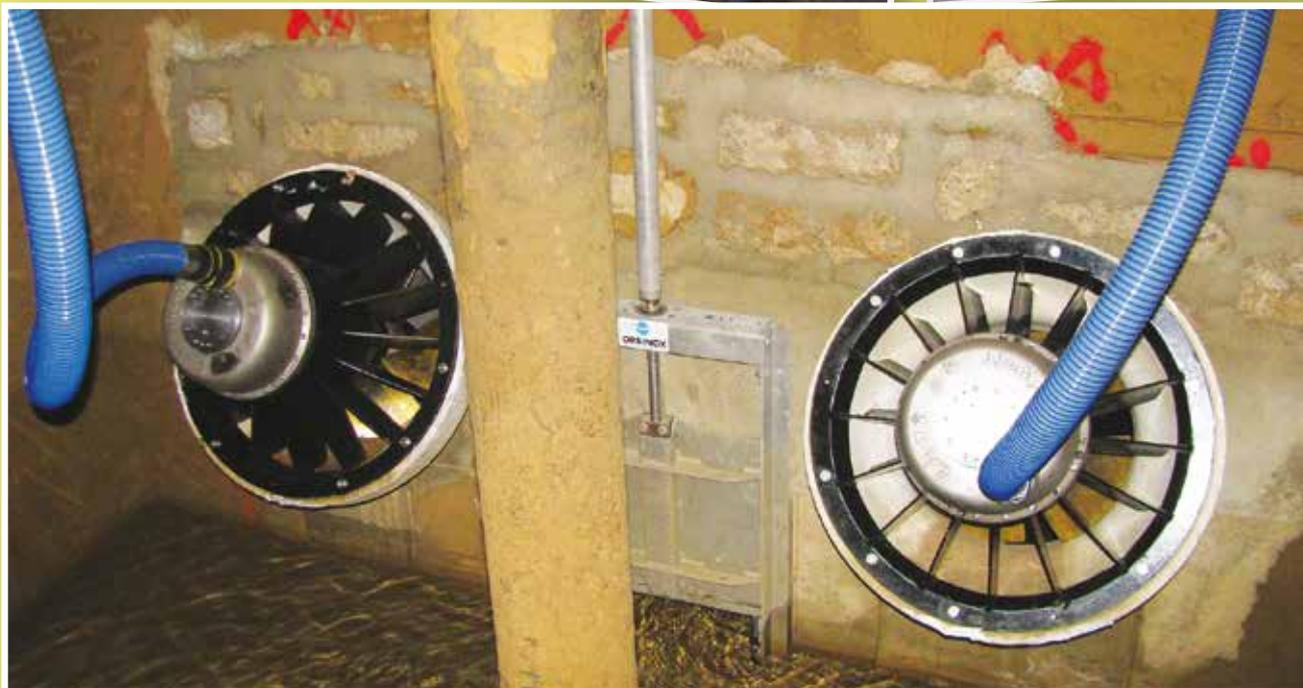
*Travail terminé, les deux turbines Turbinatt sont en place, prêtes à produire. Au centre l'axe de l'ancienne turbine.*
